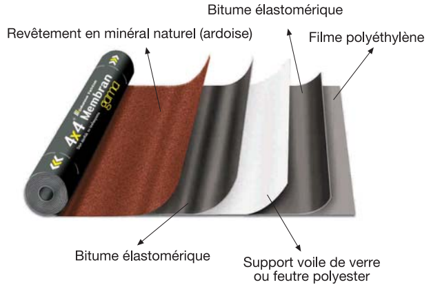
Coupe d'une membrane GAMA Ardoise
